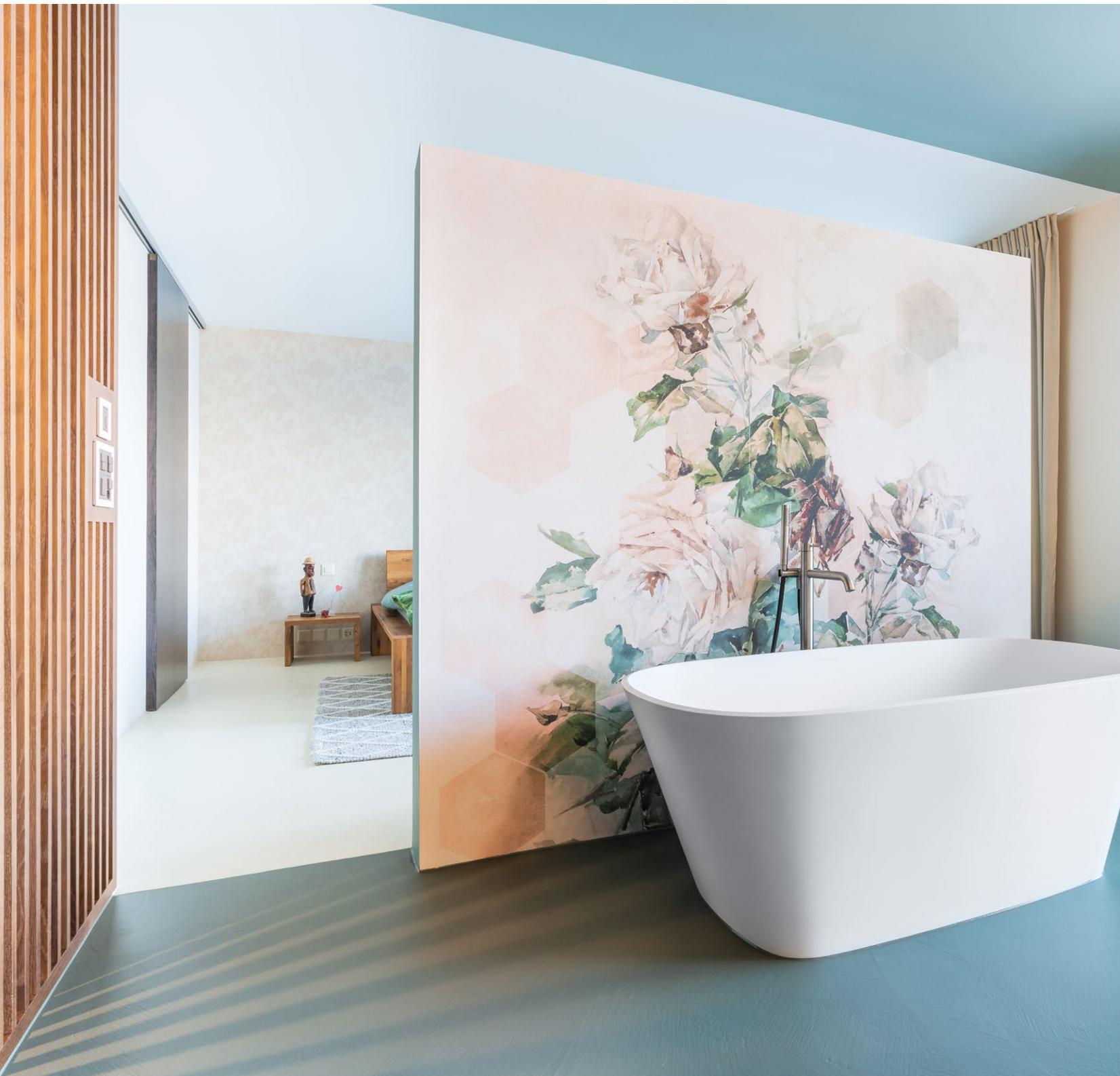
Hightechtapeten für Nasszonen sind eine attraktive Alternative zu Keramikfliesen — das Material besteht aus Fiberglas, es ist äusserst robust und kann gereinigt werden.
